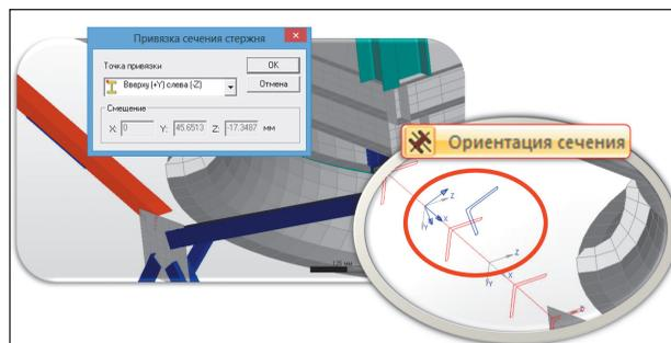
Рис. 3. Отображение поперечного сечения стержня при его повороте с учетом заданного эксцентриситета
