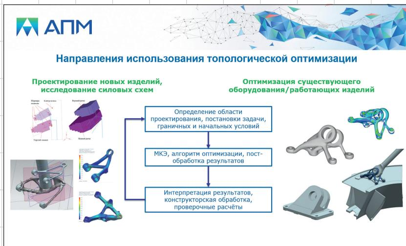
Рис. 7. Основные направления применения расчета топологической оптимизации
