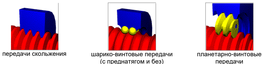
Рис. 1.1 – Классификация винтовых передач, рассчитываемых APM Screw .
