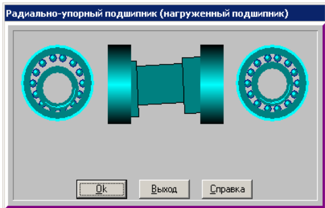
Рис. 1.12 Фрагмент анимации движения для шарикового радиально-упорного подшипника.
