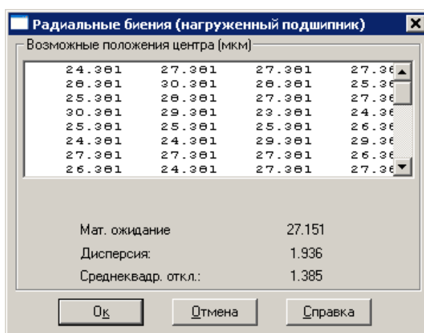
Рис. 1.8 Массив радиальных биений подшипника.
