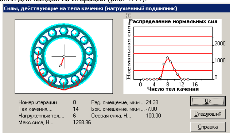
Рис. 1.14 Силы, действующие на тела качения.
