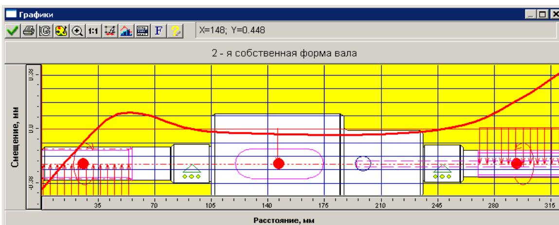
Рис. 3.42 2-я собственная форма изгибных колебаний вала
