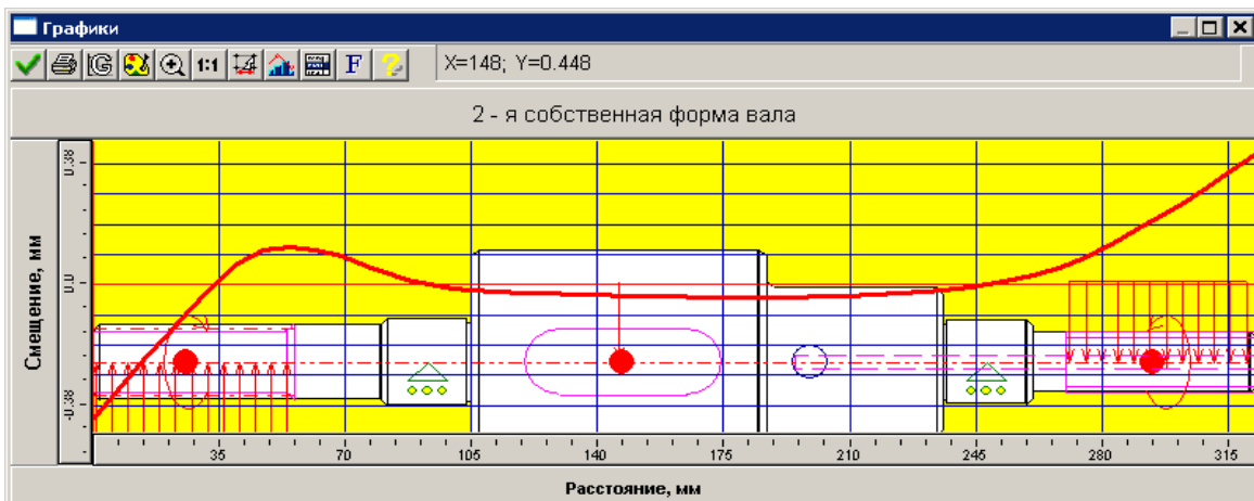
Рис. 3.42 2-я собственная форма изгибных колебаний вала
