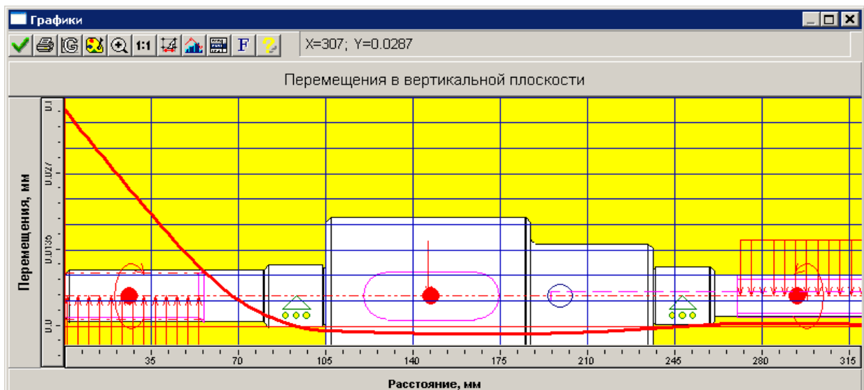
Рис. 3.38 График перемещений в вертикальной плоскости
