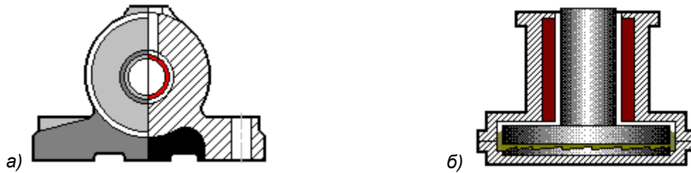
Рис. 1.1 Конструкция радиального (а) и упорного (б) подшипников скольжения.
